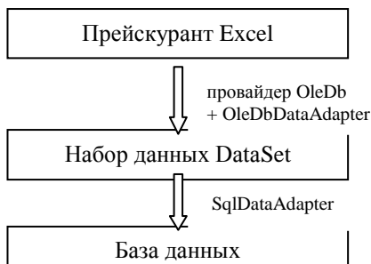
Рис.2. Схема извлечения и сохранения данных
