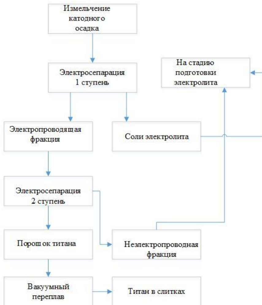
Рис1. Схема переработки катодного осадка.
