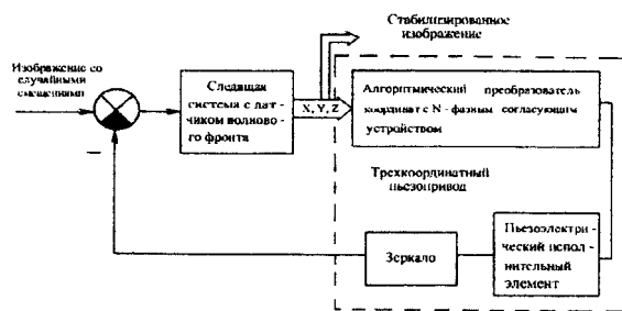
Рис. 1. Структурная схема устройства с пьезоприводом
