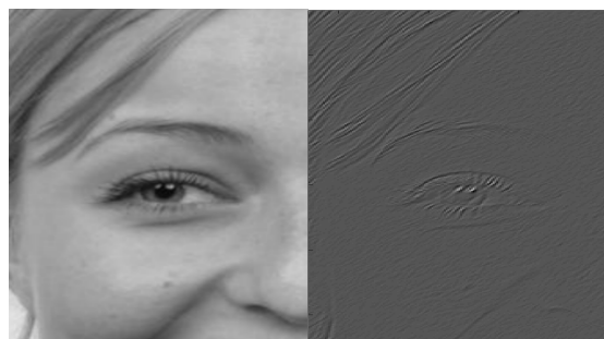
Рис. 6. Входное изображение (а) и результат фильтрации (б) с фильтром без DC
