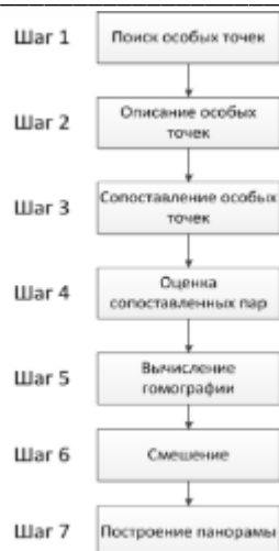
Рис. 2. Алгоритм сшивки двух изображений в панораму
