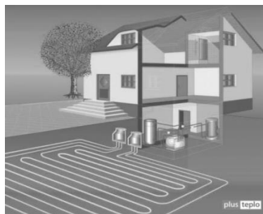
Рис. 2. Горизонтальный внешний контур теплового насоса жилого дома
