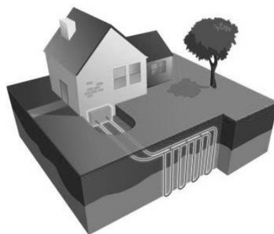
Рис. 3. Внешний контур теплового насоса вертикального типа
